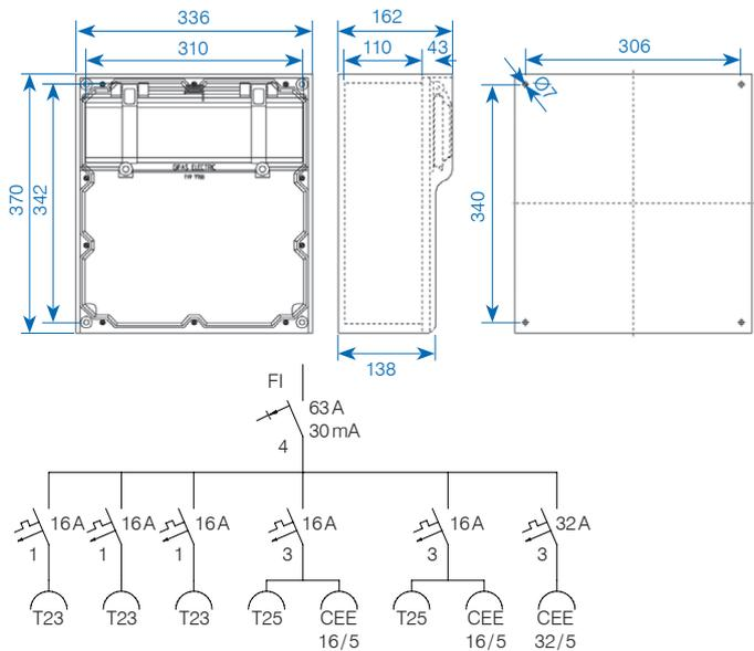
**Schaltgerätekombination Typ 7700 – 370×336×162 mm, IP44**
