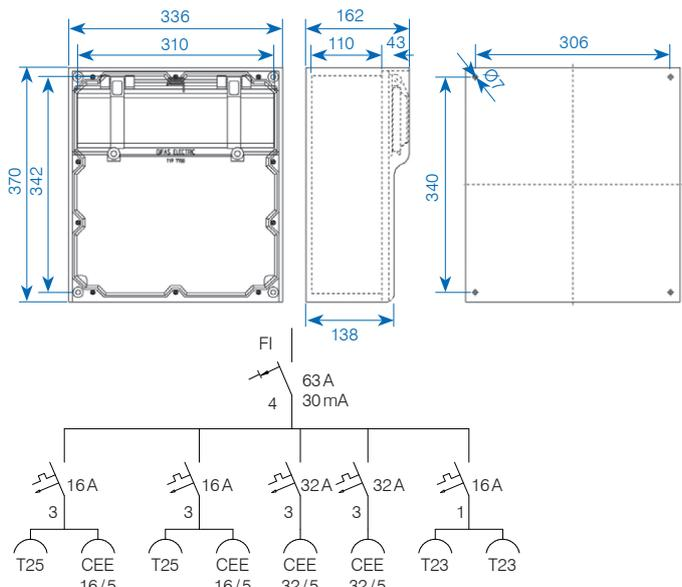
**Schaltgerätekombination Typ 7700 – 370×336×162 mm, IP44**
